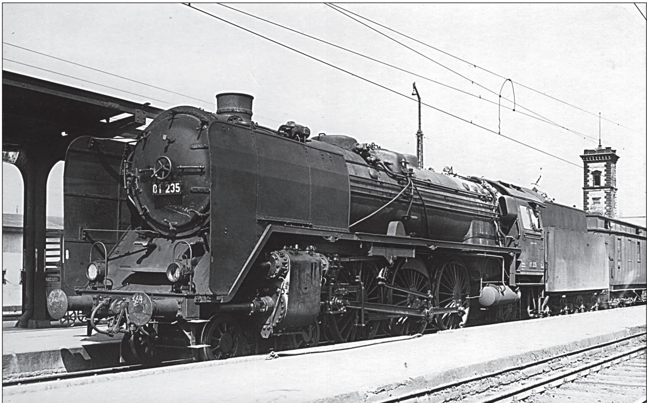
Die 01 235 war eine der zehn aus der Br 02 umgebauten Maschinen (Foto: G. Scheingraber).
