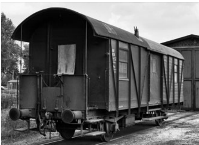
Bild 400 – Auch der vor dem Lokschuppen in Beckedorf stehende Packwagen 0136, der von dort aus meist in Richtung Munster unterwegs war, wurde von der OHE aus einem Güterwagen umgebaut. Der Spender-Wagen 1060 stammte von der Werkbahn der Fa. Rheinmetall in Unterlüß.
