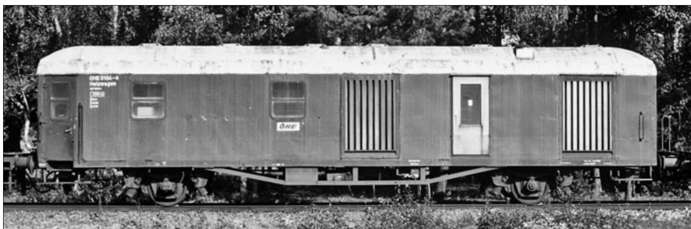
Bild 396 – Der E-Heizwagen 0104, hier am 23. September 2000 in Bergen Lagerbahnhof, wurde aus einem Bahnpostwagen umgebaut.
