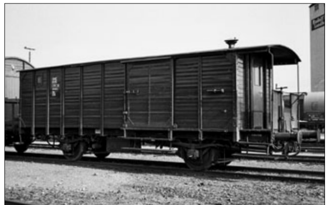
Bild 399 – Der Packwagen 0135, hier in Winsen Süd, wurde 1954 aus dem Güterwagen 1056, einem ehemals von der Kleinbahn Winsen – Evendorf – Hützel stammenden G-Wagen, umgebaut. AUFNAHME: HANS DIERKEN
