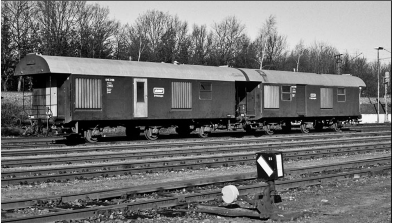
Bild 397 – Gleich beide aus Dreiachser-Umbauwagen entstandenen Heizwagen (links der 0106, rechts der 0105) warteten im Februar 1991 in Celle Nord auf den nächsten Einsatz.
