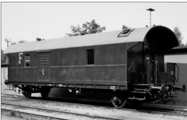
Bild 398 – Deutlich zu erkennen ist beim Wagen 0118 das Rolltor, das bereits von der DB eingebaut worden war (Celle Nord, Juli 1986). AUFNAHMEN (2): INGO HÜTTER
